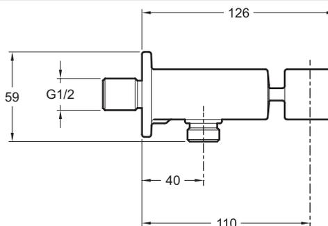
Спецификация продукта : Коленное соединение с держателем. E14791. Коллекция : Общая категория. ВЕС : 0.8 кг. МАТЕРИАЛ : N/A. ТИП УСТАНОВКИ : Крепление к стене. АКССУАРЫ : Коленное соединение. НЕВОЗВРАТНЫЙ КЛАПАН : Да.
